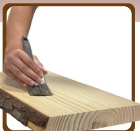
Para começar a utilizar a resina **UV-PLUS RQ-1051 média espessura**, você irá precisar de um local limpo e bem arejado e é importante preparar sua superfície corretamente. Além disso, é importante garantir que a madeira (ou superfícies porosas) esteja selada para que a resina possa ser aplicada de forma uniforme. Para isso utilize o **Selador de Madeira RQ-1020**
