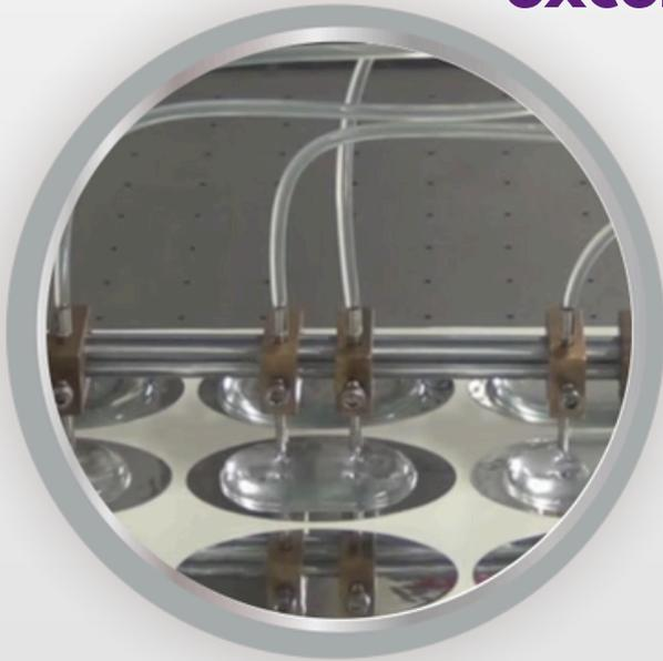
Não requer eletricidade, funciona com ar comprimido e dispensa a resina com pedal.
